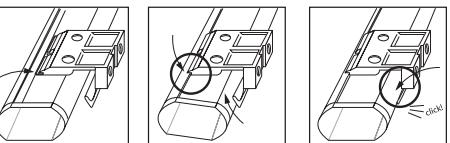
Pour le style «B» [voir l'illustration cidessous] soulevez le rail de tête en position telle que le bord avant du support est sous le bord avant intérieur du rail de tête, et puis poussez le rail de tête vers le haut jusqu'à la languette flexible au bas de chaque le support s'enclenche à l'arrière de la tête rail. Vérifiez igneusement pour vous assurer que chaque le support est correctement fixé.
