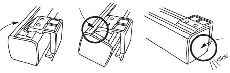
Pour le style «C» [voir l'illustration cidessous]: Pour fixer les supports, le bras de verrouillage devrait être orienté vers l'extérieur. Positionnez ensuite le support de sorte qu'il engage la face intérieure et l'arrière extérieur du rail de tête, puis poussez le bras de verrouillage vers l'intérieur pour le verrouiller endroit.
