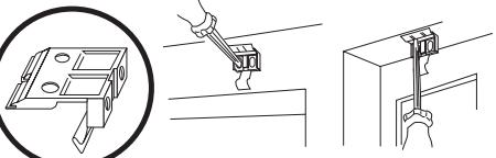
Maintenez le niveau d'store à la hauteur souhaitée et centrez-la sur la ouverture de fenêtre. Marquer l'emplacement exact de chaque support avec un crayon. Retirer les supports du rail de tête et position le haut de chaque support à la marque moulure de mur ou de fenêtre utilisant le vis 1/4", pré-percez les trous de vis à l'aide d'un Foret 3/8".
