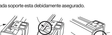
Para el estilo 'B' [mire la ilustración]: Levante el riel en posición de manera que el filo frontal del soporte de se encuentre bajo el filo interior frontal del riel superior, y presione hacia arriba hasta que la pestaña flexible en la parte inferior del soporte se encaje en la parte posterior del riel. Cerciórese que cada soporte esta debidamente asegurado.
