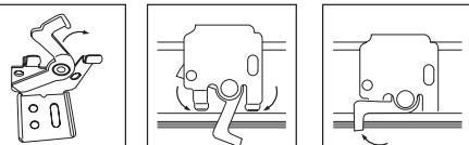
Para el estilo 'C' [mire la ilustración abajo]: Para sujetar los soportes, el brazo de aseguramiento deberá estar apuntando hacia afuera. Luego positione el soporte de manera que engancha el frente interno y posterior externo del riel, luego presione el brazo de aseguramiento hacia adentro para fijarlo en su sitio.
